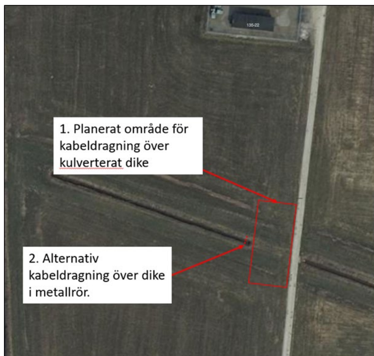
Figur 13. Lägesbeskrivning av kabeldragning över vattenområde.
